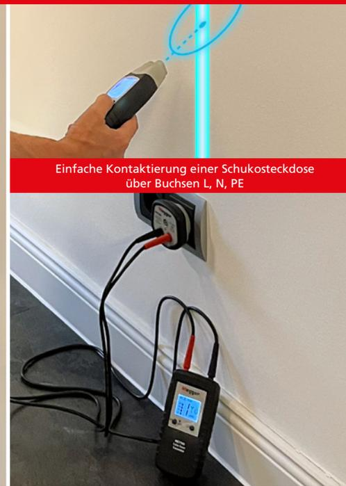
Einfache Kontaktierung einer Schuko Steckdose über Buchsen L, N, PE
